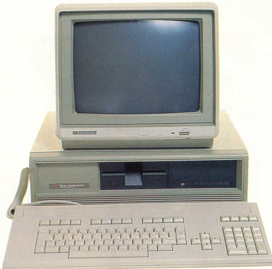
d'extension et une sortie parallèle (type Centronics). Il reste suffisamment de place pour loger une autre unité de disquette ou un disque dur type Winchester (10 Mega).
